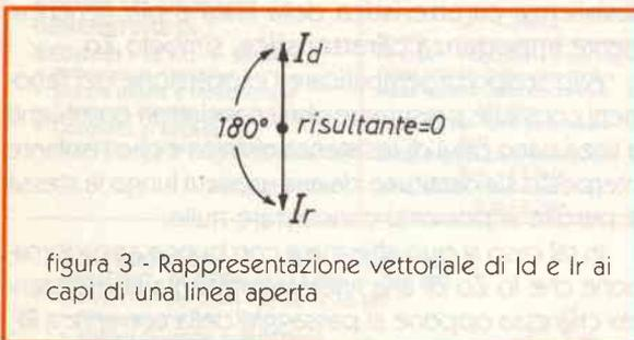
figura 3 - Rappresentazione vettoriale di  $I_d$  e  $I_r$  ai capi di una linea aperta
