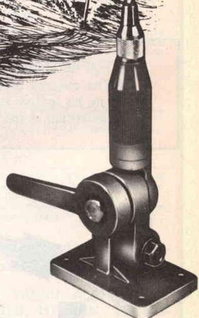
**Frequenza 26 + 30 MHz; Impedenza 50  $\Omega$ ; Potenza massima 50 W; R.O.S. 1 - 1:1; Numero canali 40; Altezza massima 160 cm.; Peso 400 gr.; Cavo RG 58 A/U m. 4; Materiale della base nylon; Materiale dello stilo fiberglass.**
